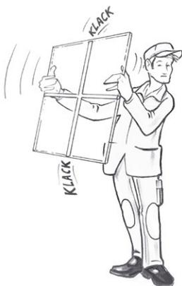
1. Innenliegende Sprossen können sich durch klimatische Einflüsse oder Erschütterungen leicht verschieben oder klappern. Dies ist unvermeidbar.
